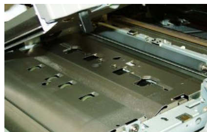
Une porte de repérage rectifie l'oblique du support et se relâche quand la feuille avance vers le détecteur d'image de contact pour affiner le réglage.
